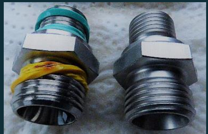
Foto 2: 316Ti (1.4571) Fittings ohne und mit Expanite Oberflächenhärtung
