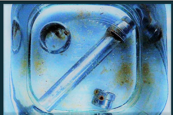
Foto 1: Komponenten aus 316Ti (1.4571) mit traditionellem Härteprozess behandelt
