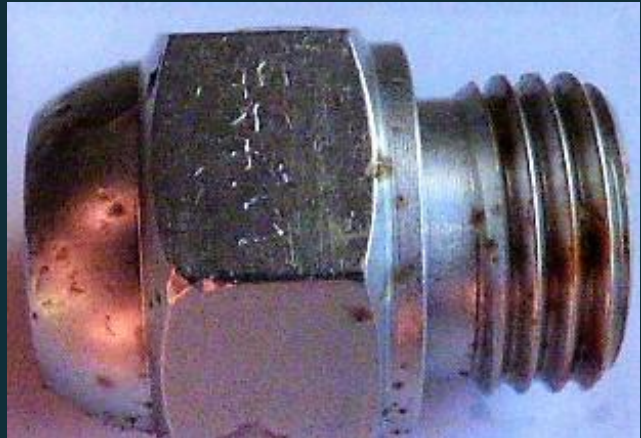
Foto 5: SuperExpanite behandelte Düse aus 303 (1.4305) Komponente mit SuperExpanite Härtung
