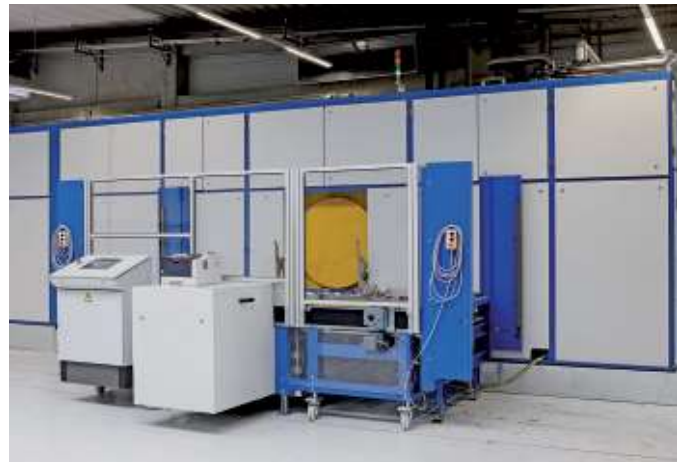
Die Entfettungsanlage von RICHARD GEISS kann bei einem Durchsatz von 12.000 Gitterboxen pro Jahr mehrere Millionen Teile reinigen.
